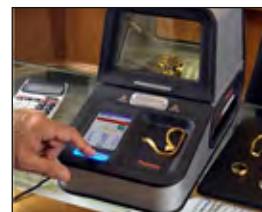
आकृति 1.2.12.2 XRF परीक्षण
